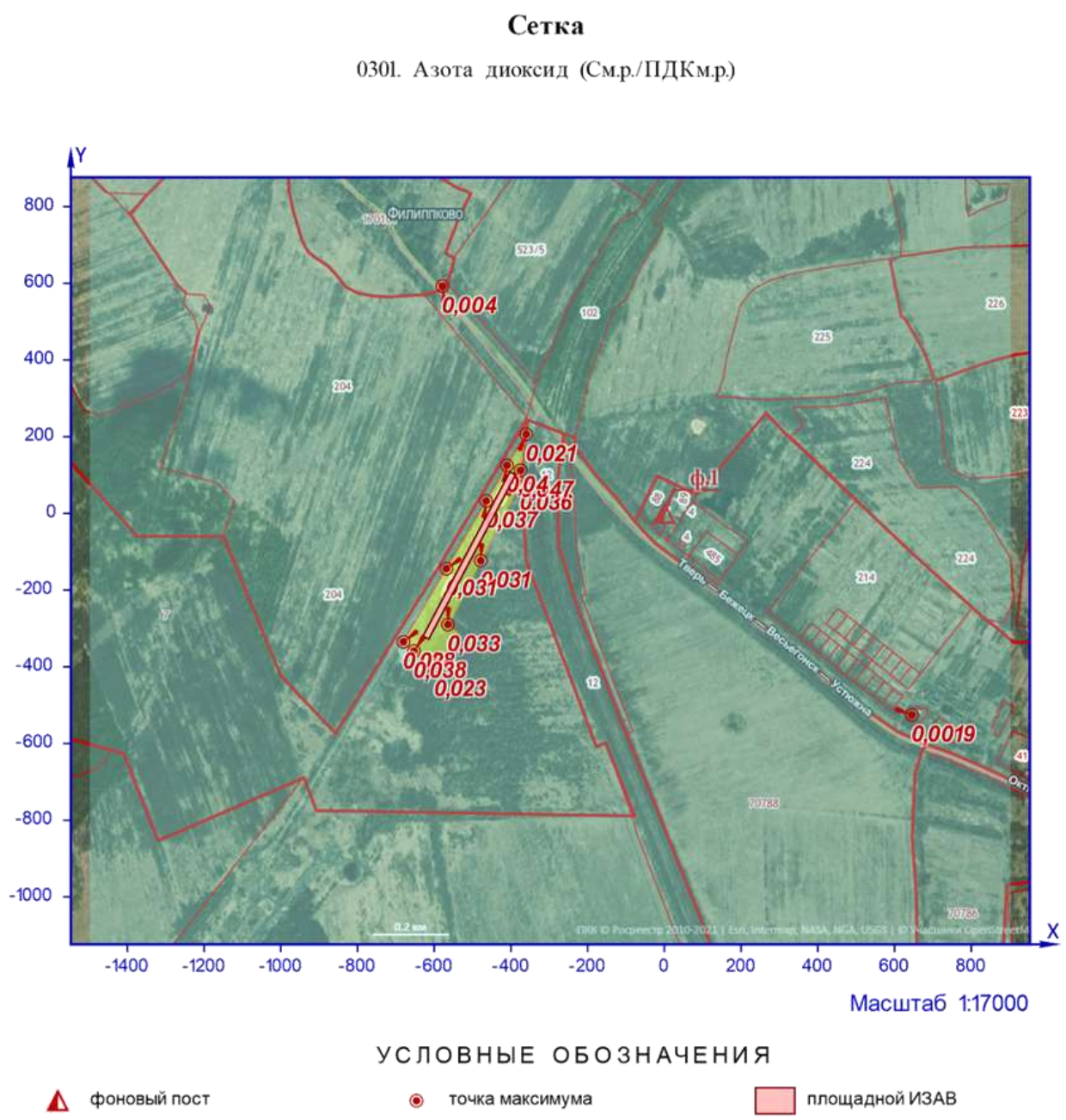
Рисунок 2.1 – Карта-схема результата расчёта рассеивания
